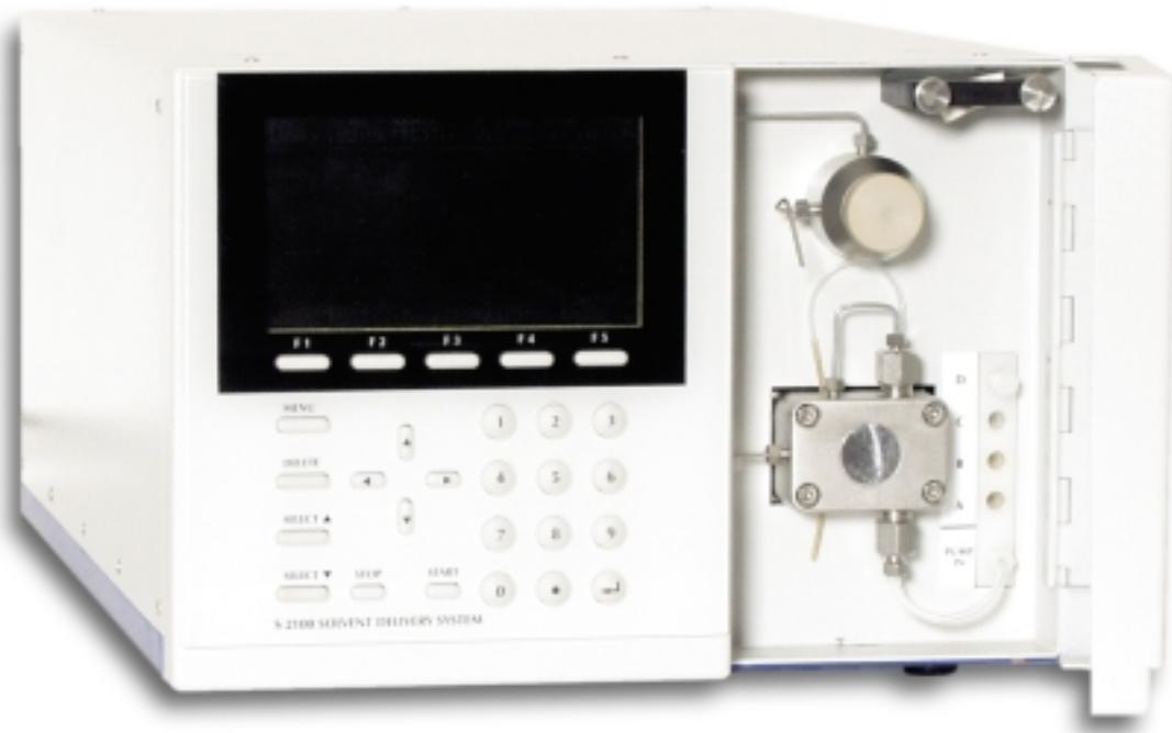
Die quaternäre Gradientenpumpe 2100 mit Optionen für alle flüssigchromatographischen Anwendungsbereiche kann mit drei unterschiedlichen Pumpenköpfen von 0,02- 40ml/min ausgestattet werden. Das Niederdruckgradienten Profil ist in 0,1 % Schritten für Lösemittel A,B,C und D programmierbar. Weiterhin ist ein integrierbarer Online-Entgaser als Einbauoption erhältlich.
